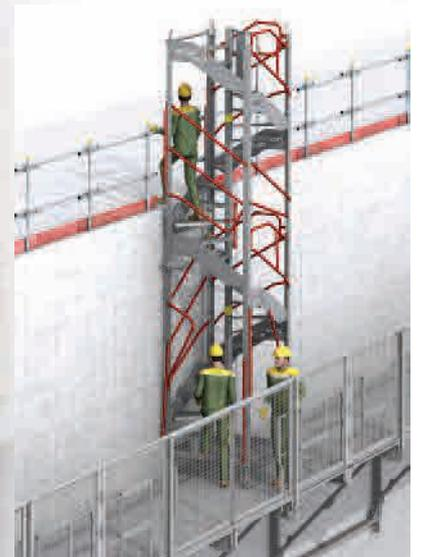
Mini Escalib Mills installé sur une passerelle (PTE).
