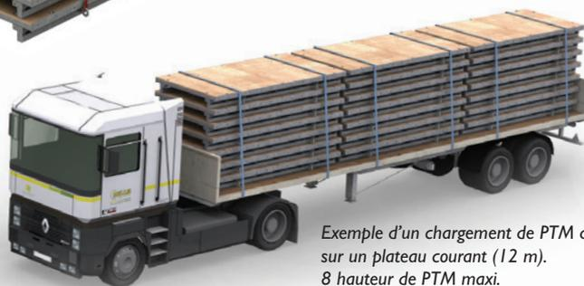
Exemple d'un chargement de PTM de 4,00 m sur un plateau courant (12 m). 8 hauteur de PTM maxi.
