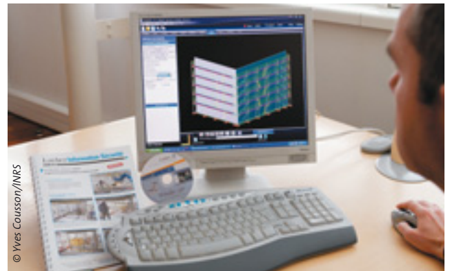
11. Projet d'échafaudage conçu à l'aide du logiciel de calepinage et d'une notice pré-établie.
